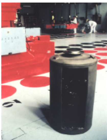
Figure 2. Colis de déchets à haute activité et à vie longue (Photo COGEMA)
