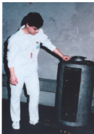
Figure 2. Colis de déchets à haute activité et à vie longue (Photo COGEMA)
