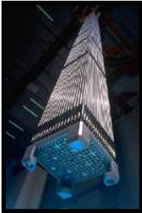
Figure 1. Vue d'un combustible nucléaire (Photo COGEMA)
